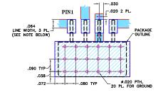
NOTES: 1.TRACE WIDTH IS SHOWN FOR ROGERS R04350B WITH DIELECTRIC THICKNESS 0.030" ± 0.002"; COPPER: 1/2 02, EACH SIDE. FOR OTHER MATERIALS TRACE WIDTH MAY NEED TO BE MODIFIED. 2.BOTTOM SIDE OF THE PCB IS CONTINUOUS GROUND PLANE.
